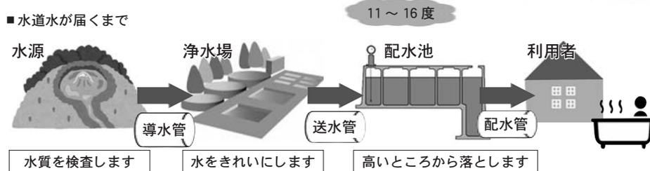
管路の延長は約180km(導水管:約7km、送水管:約17km、配水管:約156km)にもなり、耐用年数は法律で40年と定められています。古くなった管は、耐震性のあるものに計画的に更新しています。
